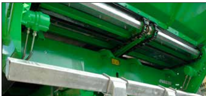
Transportbodenantrieb über zwei Hydraulikmotoren
